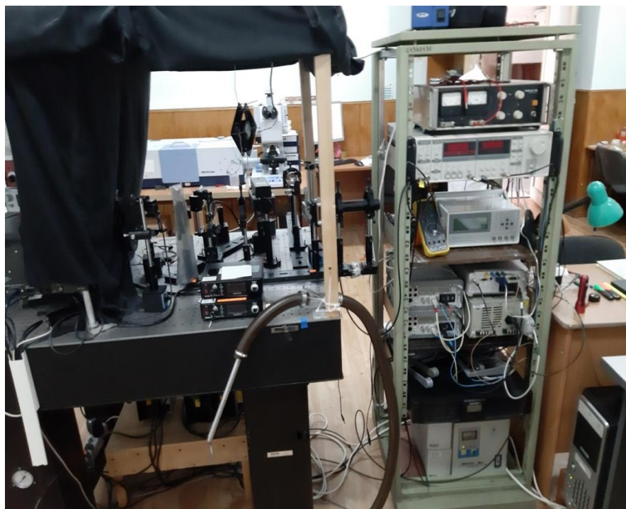
Рисунок 2.8.4 - Установка для измерения спектров фотоотклика и вольтамперных характеристик меза-диодных структур и меза-резисторов
